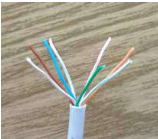
Рисунок 3 – Очистка кабеля от изоляции
