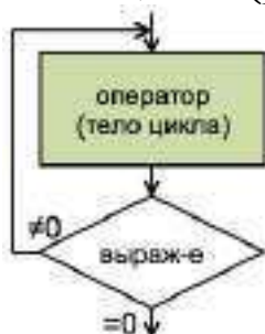
Рис. 3.8. Алгоритм работы оператора do-while
