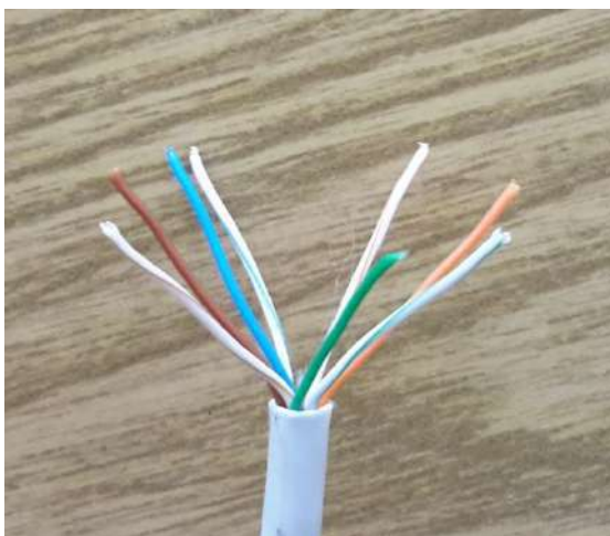
Рисунок 3 – Очистка кабеля от изоляции
