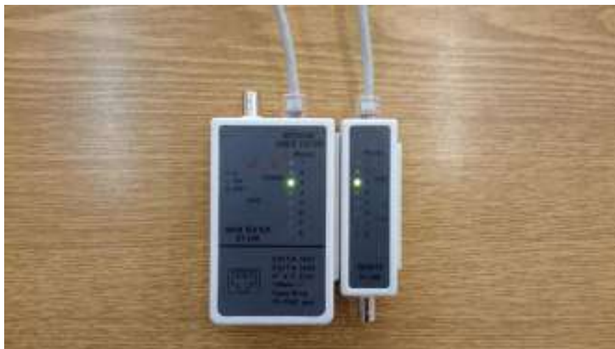
Рисунок 9 – Проверка кабеля тестером
