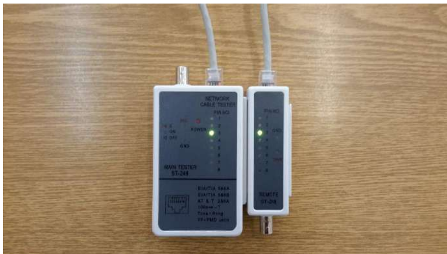
Рисунок 9 – Проверка кабеля тестером
